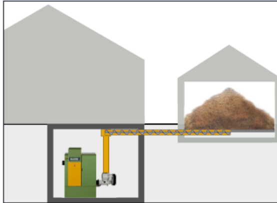
Beispiel: Lagerraum in separatem Gebäude, Verbindung über Förderschnecke und Fallrohr
