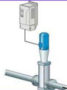
Variador de velocidade
